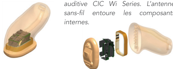
Figure 2 : Vue de côté d'une aide auditive CIC Wi Series désassemblée. Les cache-microphone et tiroir-pile sont visibles sur la plaque-circuit. Les composants tiennent à l'intérieur de l'antenne sans-fil, qui se glisse à l'intérieur de la coque.
