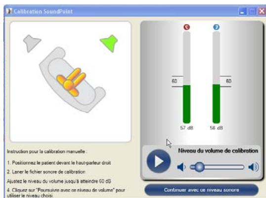
Figure 2. Processus d'étalonnage avec le logiciel SoundPoint
