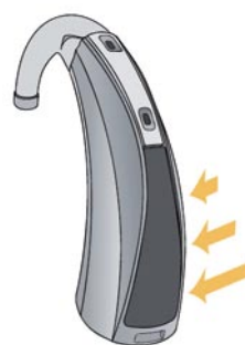
Dessin 2b. Les flèches illustrent le mouvement de pression qui, par défaut, déclenche un changement de programme.
